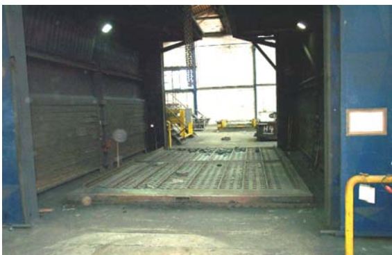
Рис. 1. Выбивная камера проходного типа имеет двойную решетку
