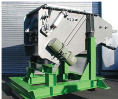
Рис. 5. Дробилка комьев смеси (внешний вид)
