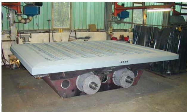
Рис. 4. Выбивная решетка с приводом для выполнения круговых колебаний
