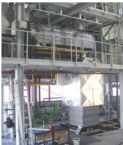
Рис.13. Камера накаливания с псевдоожигением (завод VAW Aluminium-technika Kft, Н – Győr)
