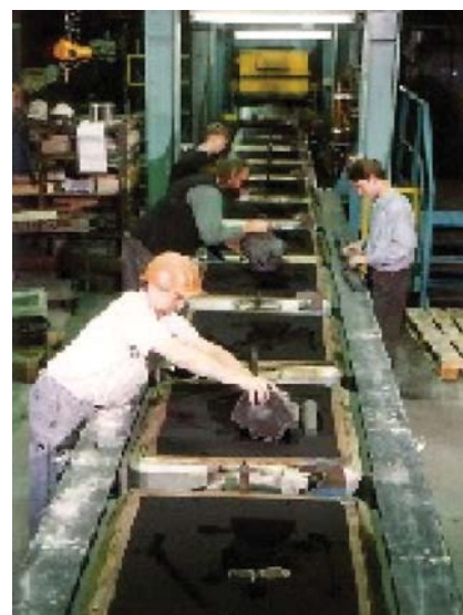
Рис. 6. Участок простановки стержней на формовочной линии
