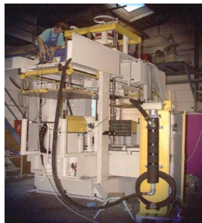
Рис. 17. Общий вид стержневого автомата типа L40, комплект со смесителем типа LM4.2 и газогенератором LG1.5, на котором производят стержни для водопроводной арматуры по Амин-Cold-box-процессу на заводе «Клоу Валь» концерна McWane
