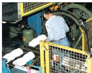
Рис.2, а, б. Участок простановки стержней в форму на формовочной линии HWS (Генрих-Вагнер-Синто) типа EFA-SD 5.5. Формовочный автомат работает по методу CEI/ACU – воздушный поток с доуплотнением многоплунжерной головкой
