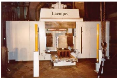
Рис. 14. Общий вид стержневого автомата типа L120, комплект со смесителем типа LM5.5 и газогенератором LG2, на котором производят стержни для отливок водопроводной арматуры по Амин-Cold-box-процессу на заводах «Тайлер Пайп» и «Юнион Фаундри» концерна McWane
