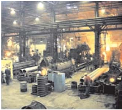
Рис. 9. Производство центробежнолитых труб из высокопрочного чугуна на одном из заводов американского концерна McWane
