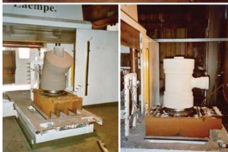
Рис. 15. Общий вид стержневого автомата типа LFB200 во время производства стержней для крупногабаритной водопроводной арматуры по Амин-Cold-box-процессу на заводе «Юнион Фаундри» концерна McWane
