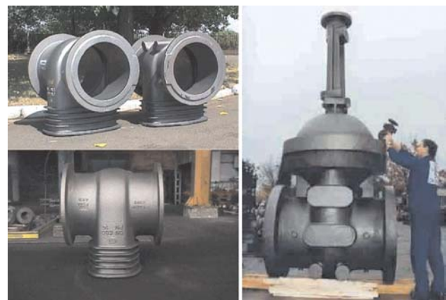
Рис.8. Примеры чугунных и стальных отливок арматуры, которые производят заводы группы Tyco Waterworks Europe в Восточной Европе
