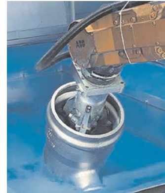
Рис. 7. Антикоррозионная обработка отливок
