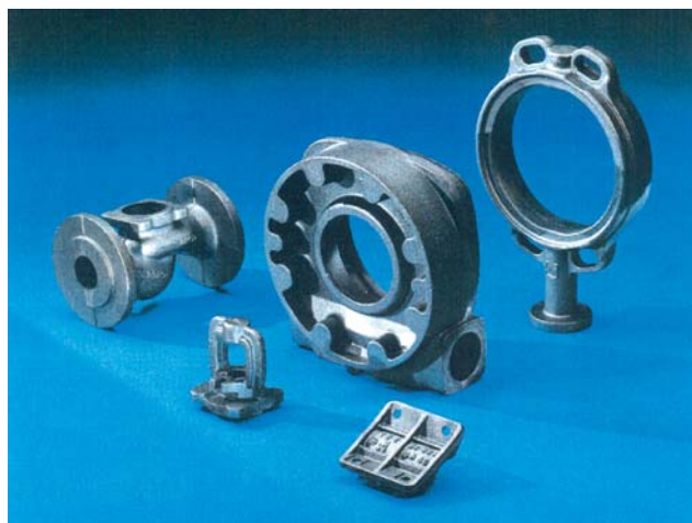
Рис.2. Типовые отливки, полученные на линии горизонтальной безопочной формовки фирмы HWS (Германия) типа FBO-III S, размер формы 500x600x130–200/130–200 мм, производительность 170 форм/ч. Производитель отливок – завод Zetkama, Польша
