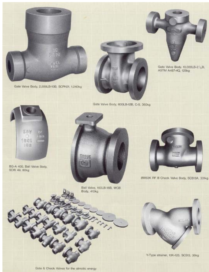
Рис.6. Типовые отливки стальной арматуры от 3 кг и более 1,24 т. Формы изготовлены вакуум-процессом (V-process). Производитель отливок – завод Nissha Wasino Steel Co, Япония
