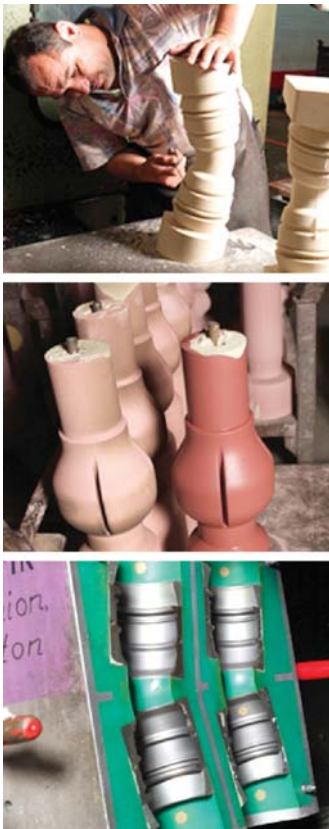
Рис.12. Изготовление стержней для арматурных отливок на фирме DÜKER GmbH, Германия. В 1986 г. фирма Laempfe поставила на этот завод стержневые автоматы LKV12, LKV25, а в 2001 г. – производственный центр на базе стержневой машины L40
