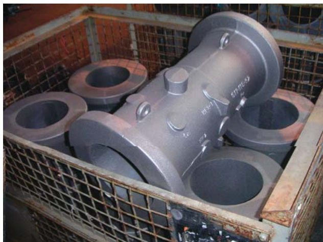
Рис.3. Арматурные отливки из ВЧ, диаметр 350 мм. Формы изготовлены на линии фирмы HWS (Германия), размер опоки 1000x800x350/350 мм. Производитель отливок – завод «Брехман», Германия, и другие предприятия, например, завод «Фришхут», Германия
