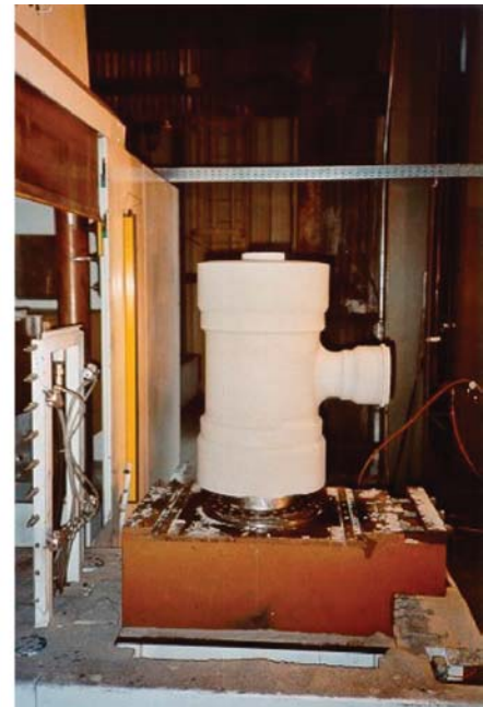
Рис.13. Изготовление стержней диаметром 800 мм на стержневом автомате LFB200V фирмы Laempfe на фирме Union Foundry (США). Стержни изготавливают Амин-процессом
