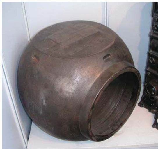
Рис.7. Отливка «Шаровой клапан». Форма получена вакуумно-пленочной формовкой. Сталь, масса отливки 390 кг. Производитель – P & S Guss GmbH, Германия
